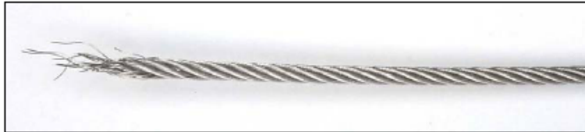
Rupture arrière du câble de commande à cabrer (échelle 1 :1)
